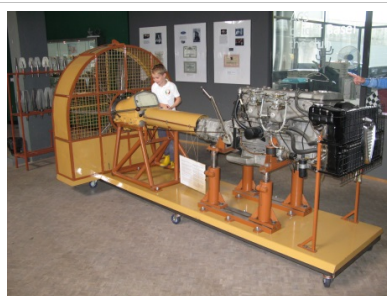
Motorenprüfstand zu Bestimmung der Brake-HP
